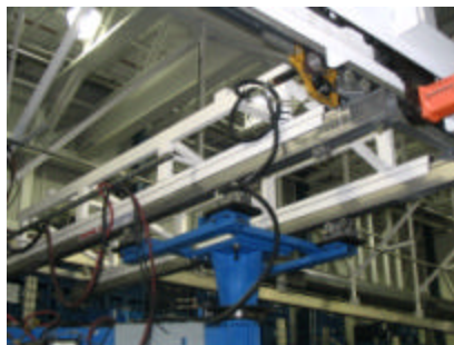
Pont roulant de 20' avec renfort et potence mobile Paccar
