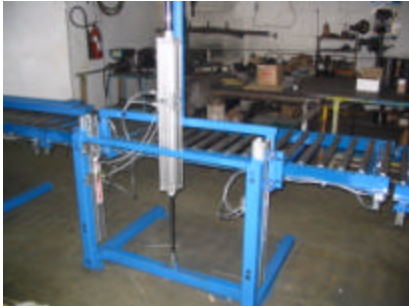
Convoyeur à rouleaux guidé verticalement Lumec
