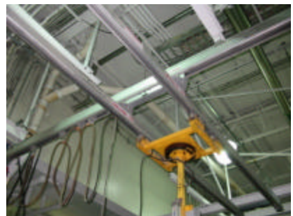
Manipulateur mobile et rotatif avec mouvement vertical Paccar
