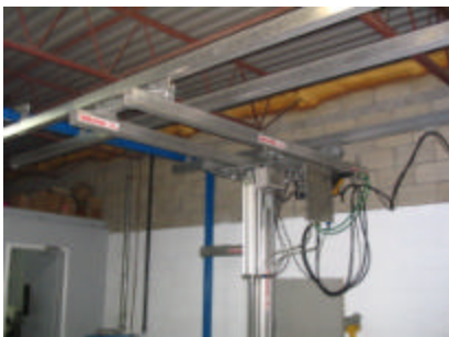
Manipulateur à mouvement vertical et horizontal GM (Boisbriand)
